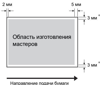
\* Указанные значения верны при использовании бумаги стандартного размера. При использовании бумаги нестандартного размера эти значения составляют 5 мм.
