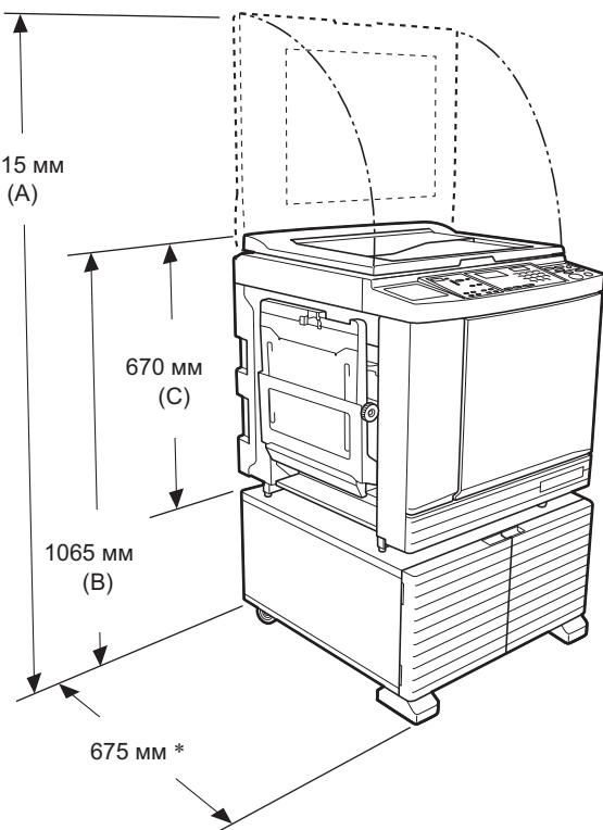
При установке дополнительного автоматического податчика оригиналов используйте следующие значения от (A) до (C) на приведенном выше рисунке.
