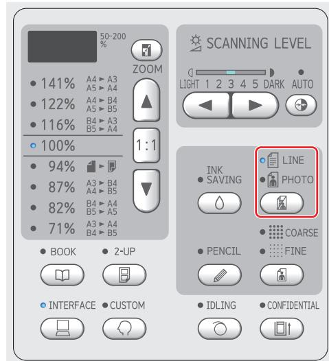
Настройка изменяется при каждом нажатии клавиши [LINE/PHOTO].
