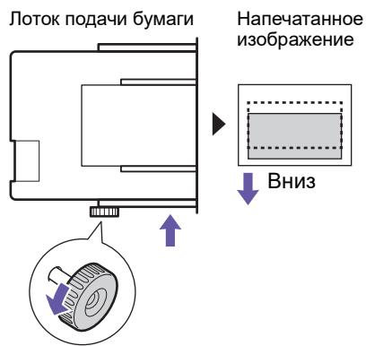
По мере смещения лотка подачи бумаги к задней части аппарата напечатанное изображение соответственно сдвигается вниз на бумаге.
