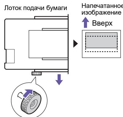
По мере смещения лотка подачи бумаги к передней части аппарата напечатанное изображение соответственно сдвигается вверх на бумаге.
